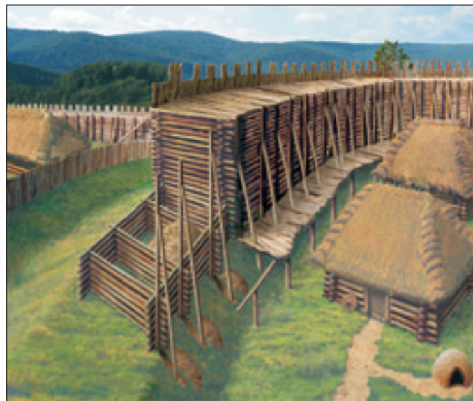
Rekonstrukcja techniki budowy wału grodu fazy IV w Naszacowicach (po 989 r.)
