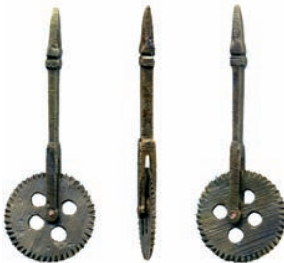
Radelko introligatorskie do wytłaczania ornamentów w skórnych oprawach książek, zabytek datowany ramowo od drugiej połowy XVI do XVIII w.
